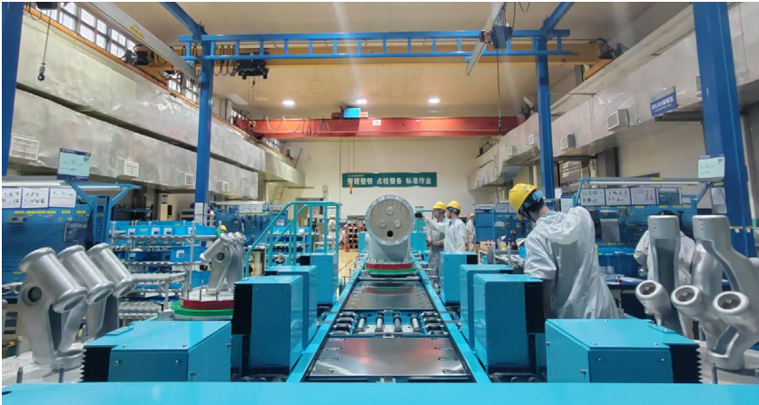
三工位自动化装配线
